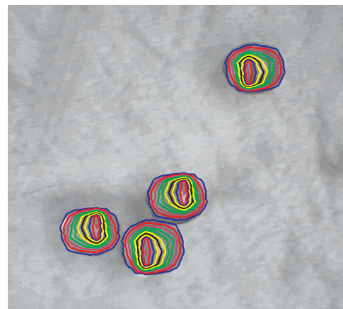
Abb. 1. UV/Vis-Videobild und IR-Rekonstruktion von vier Polystyrol-Harzbeads mit einem Durchmesser von ca. 80\text{ }\mu\text{m} . Die IR-Karte wurde mit einem motorgetriebenen x-y-Verstellschiebetisch in Kombination mit einem IR-Mikroskop erhalten. Zur Rekonstruktion der Harzbeads wurde das Integral der Polystyrol-Kombinationsschwingung bei 1942\text{ cm}^{-1} verwendet.
